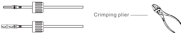
Figura 5.4 Crimpe o pino de contato no fio
