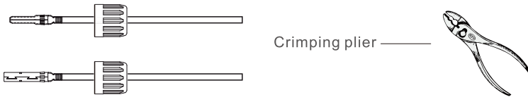
Figura 5.4 Crimpe o pino de contato no fio
