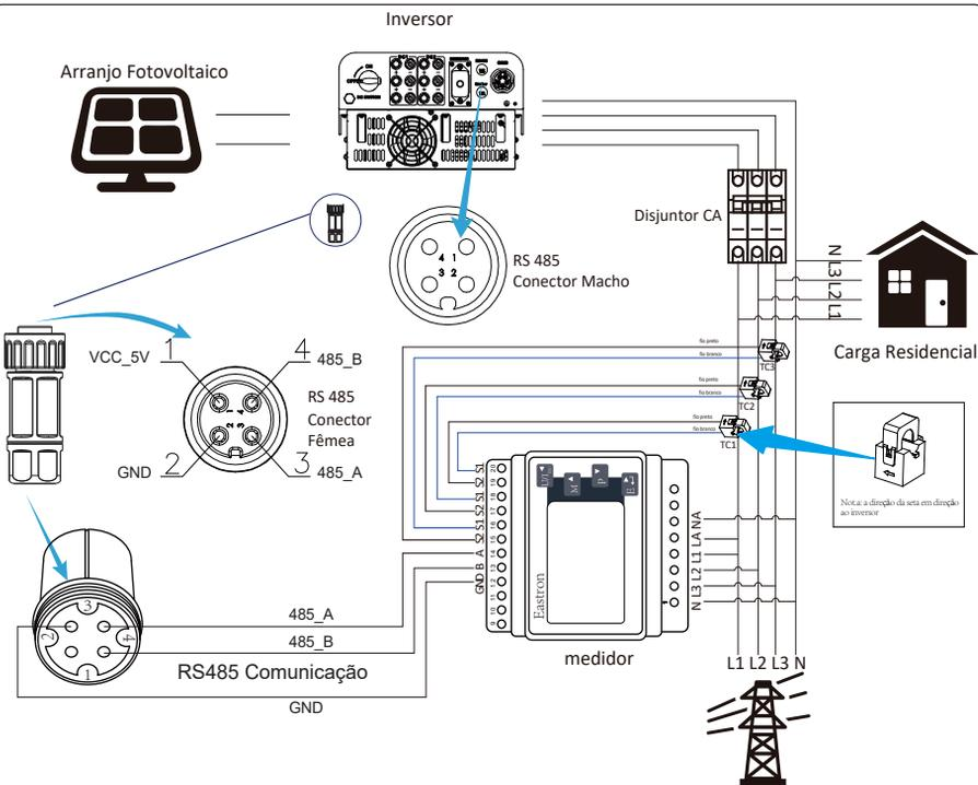
Figura 14 Diagrama da Comunicação do medidor Eastron
