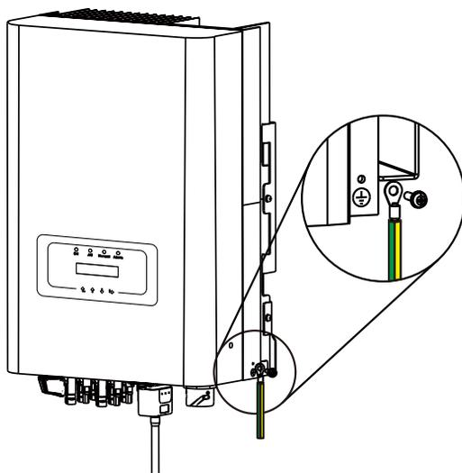
Figura 5.11 A instalação do Aterramento da Carcaça
