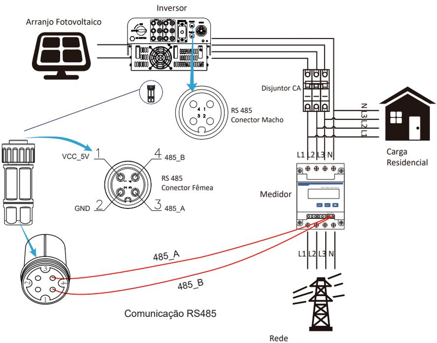
Figura 7.16 Conexão do diagrama do medidor CHINT
