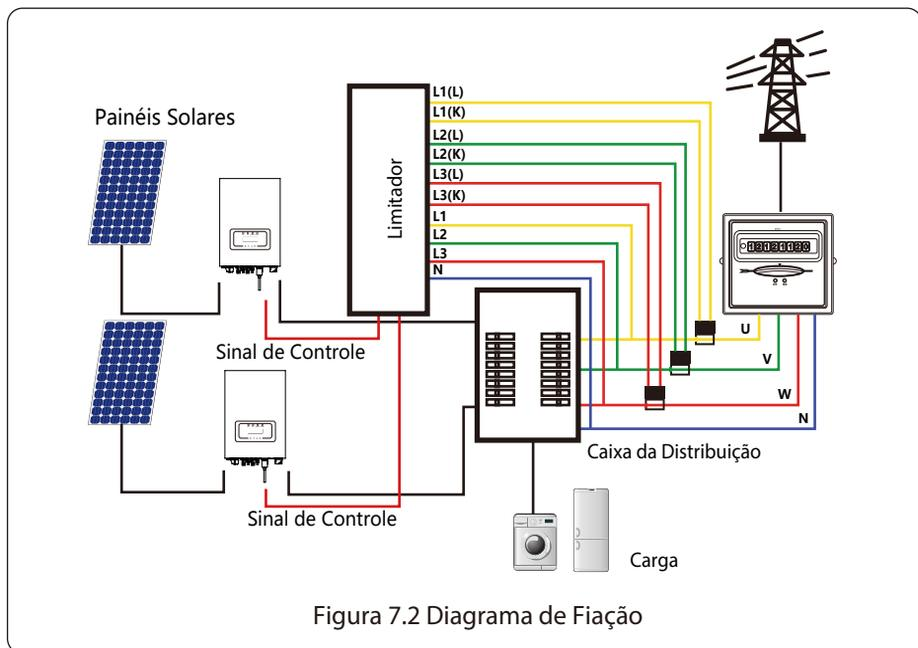
Figura 7.2 Diagrama de Fiação
