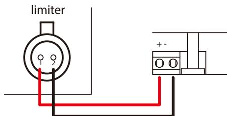
Figura 7.6 Conexão do limitador ao inversor
