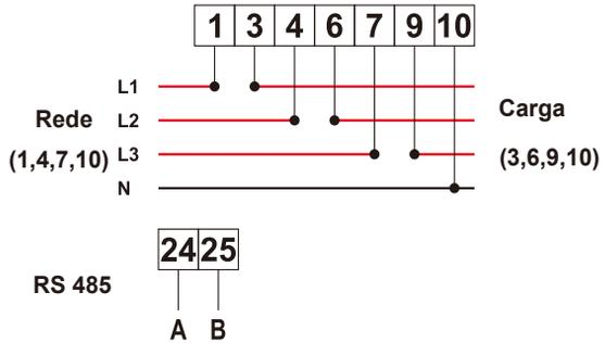
Figura 7.15 Medidor CHINT
