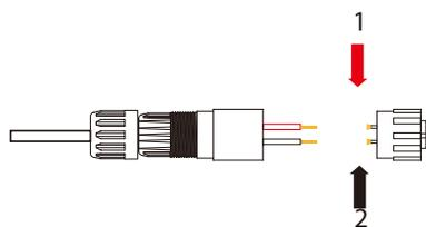
Figura 7.5 Terminal à prova d'água
