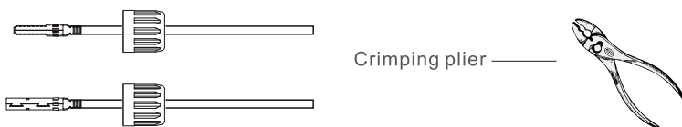
Figura 5.4 Crimpe o pino de contato no fio
