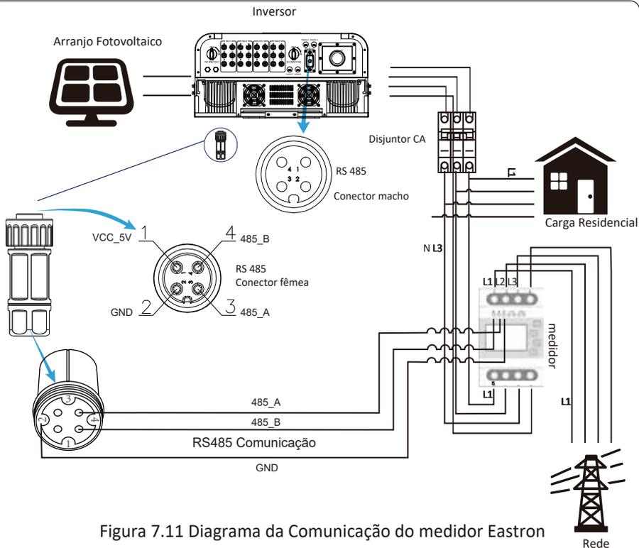
Figura 7.11 Diagrama da Comunicação do medidor Eastron
