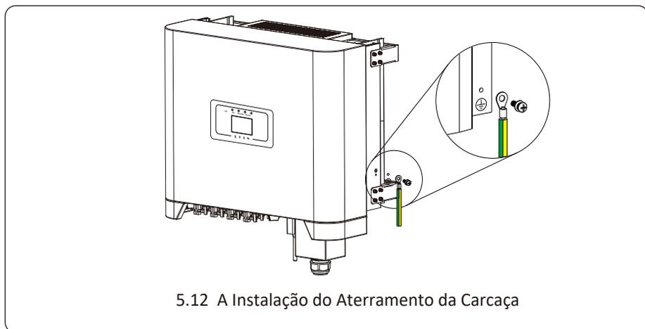
5.12 A Instalação do Aterramento da Carcaça
