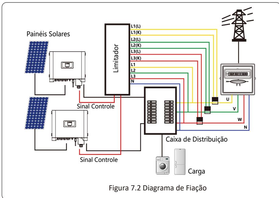
Figura 7.2 Diagrama de Fiação
