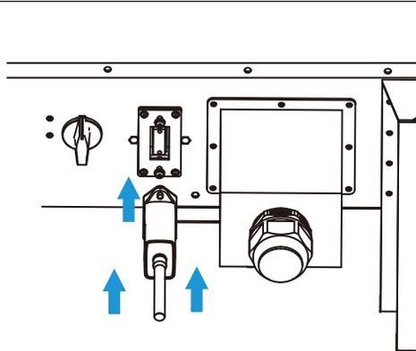
Figura 5.14 Diagrama de Instalação do Wi-Fi
