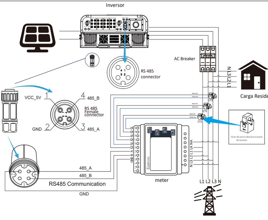
Figura 7.13 Diagrama de conexão com o medidor Eastron
