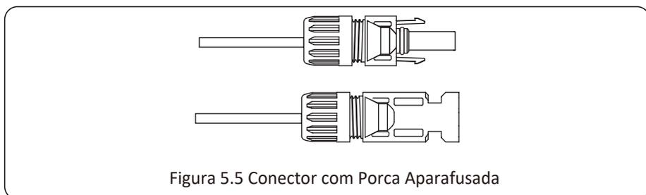
d) Por fim, insira o conector CC na entrada positiva e negativa do inversor, conforme figura 5.6
