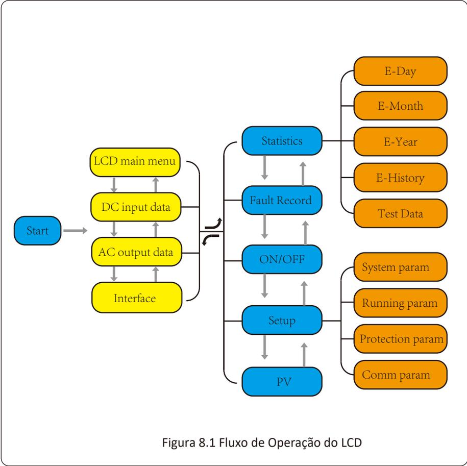
Figura 8.1 Fluxo de Operação do LCD
