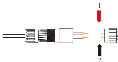
Figura 7.5 Terminal à prova d'água
