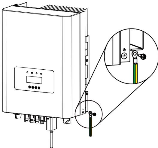
Figura 5.11 A instalação do Aterramento da Carcaça
