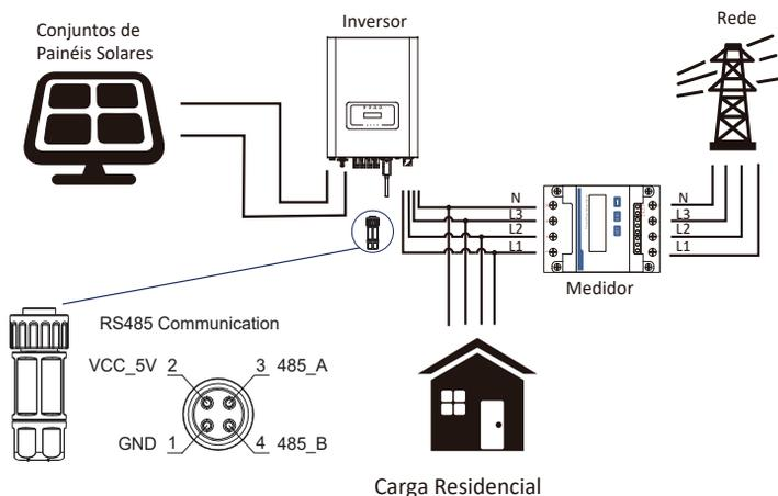
Figura 7.16 Conexão do diagrama do medidor CHINT
