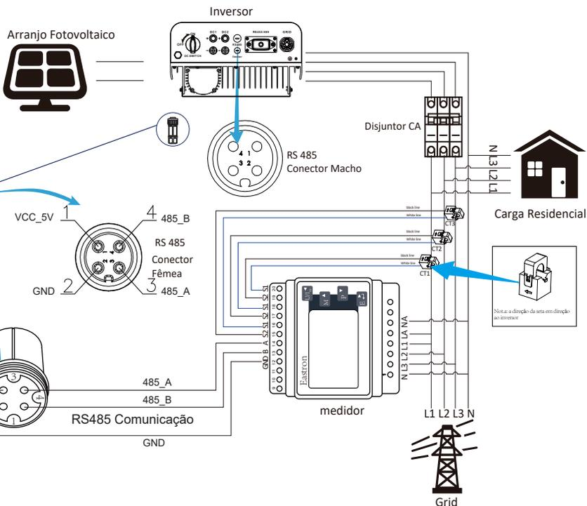
Figura 14 Diagrama da Comunicação do medidor Eastron
