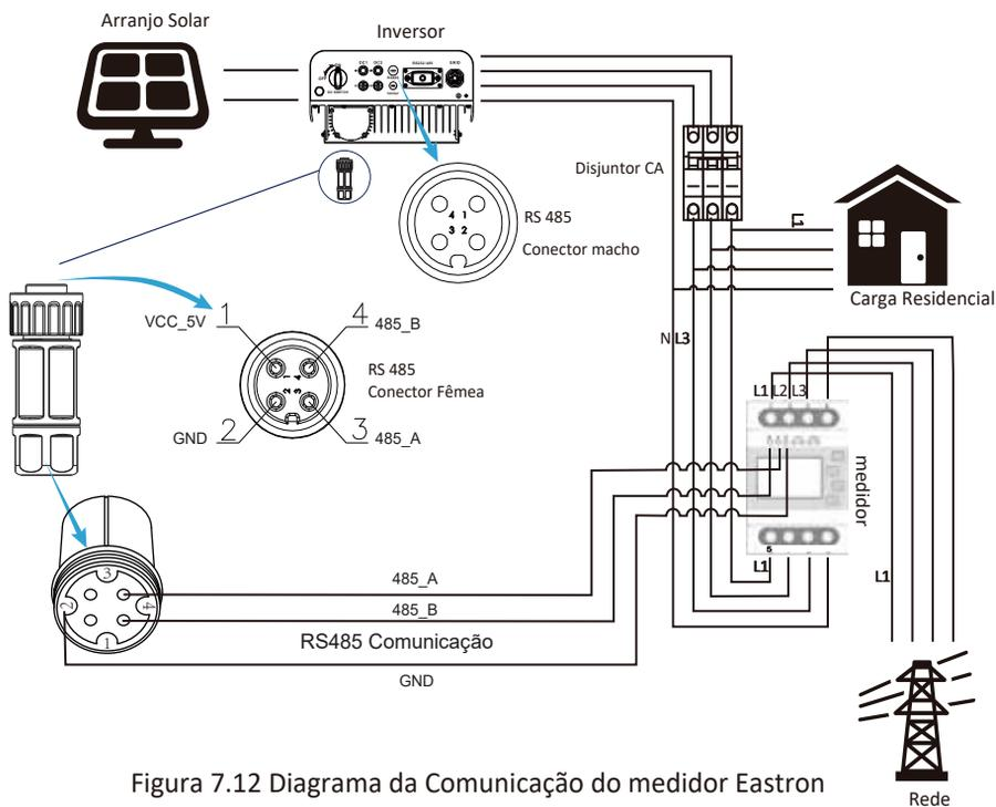
Figura 7.12 Diagrama da Comunicação do medidor Eastron
