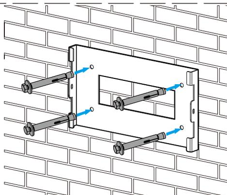
Figura 4.5 Instalação da placa de suspensão do inversor
