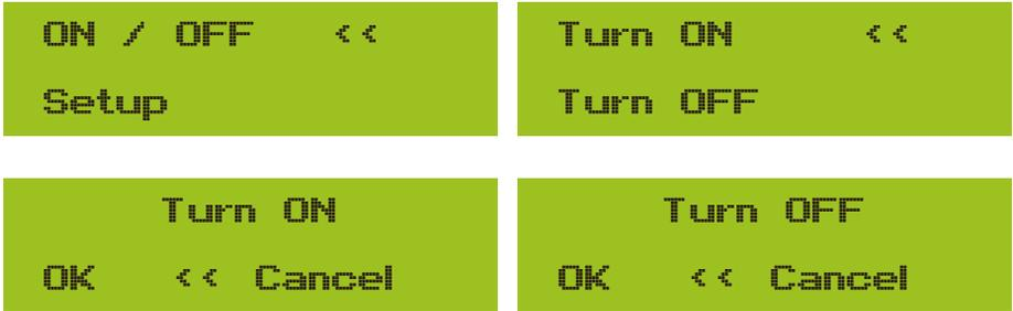
Figura 8.15 Configuração ON/OFF
