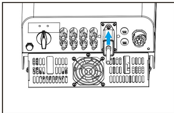
Figura 5.13 Diagrama de Instalação do adaptador Wi-Fi
