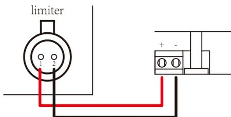
Figura 7.6 Conexão do limitador ao inversor
