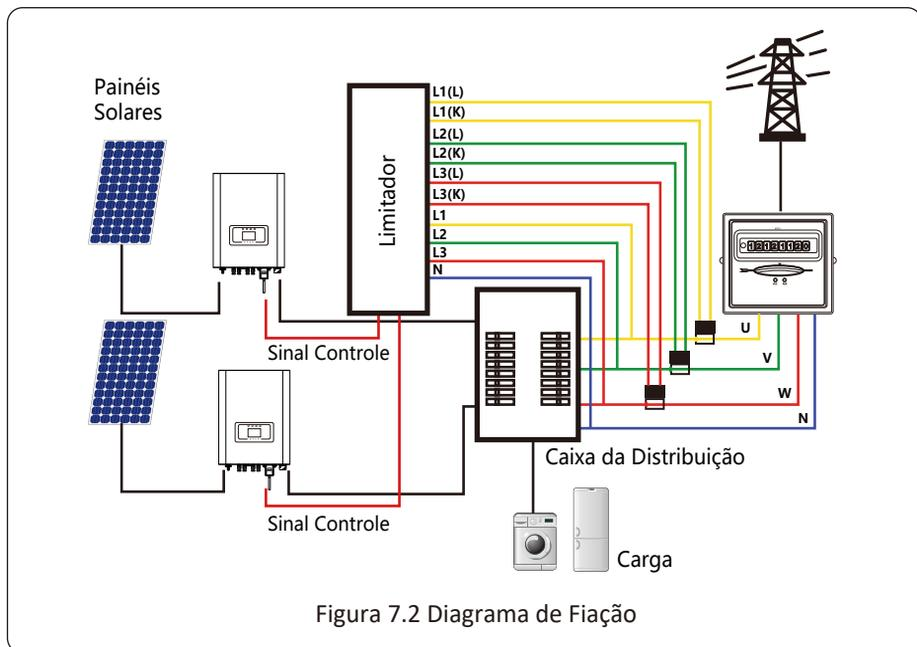
Figura 7.2 Diagrama de Fiação
