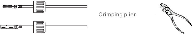
Figura 5.4 Crimpe o pino de contato no fio
