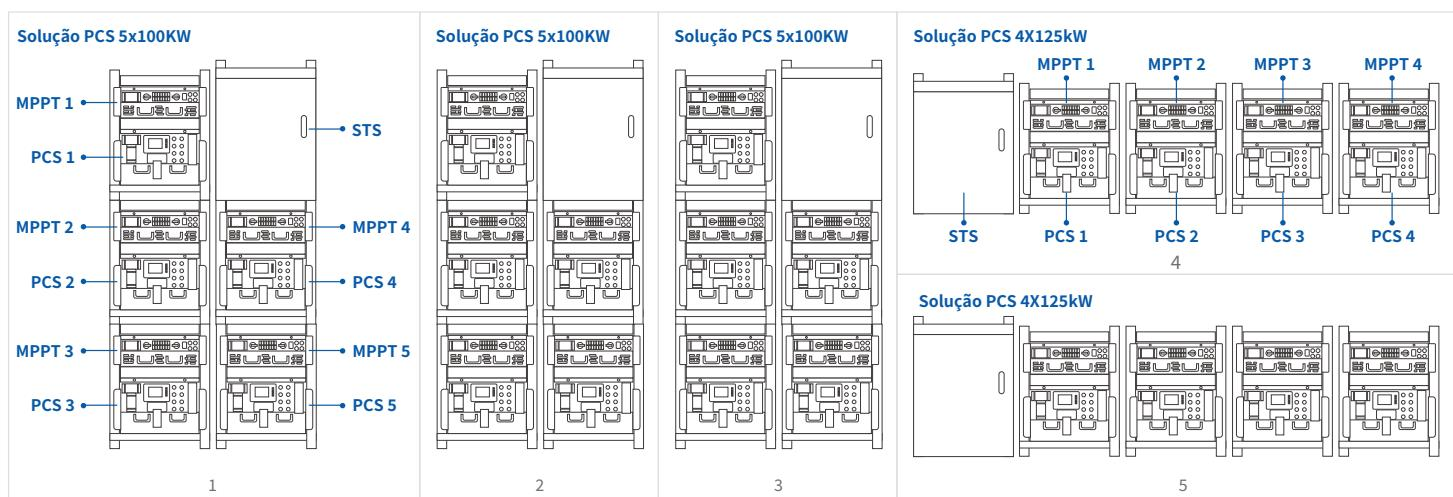
Até cinco módulos STS podem ser conectados em paralelo para formar um sistema de 2,5 MW
