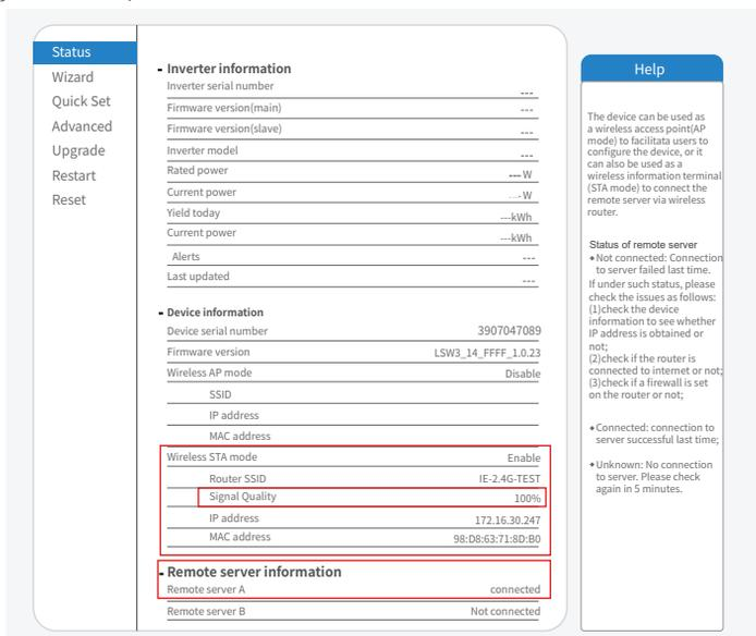
10. Quando mostra " conectado", significa que este Microinversor conectou a plataforma solarman com sucesso. De modo geral, ele estará online após 10-15 min a pós a configuração bem-sucedida na primeira vez.
