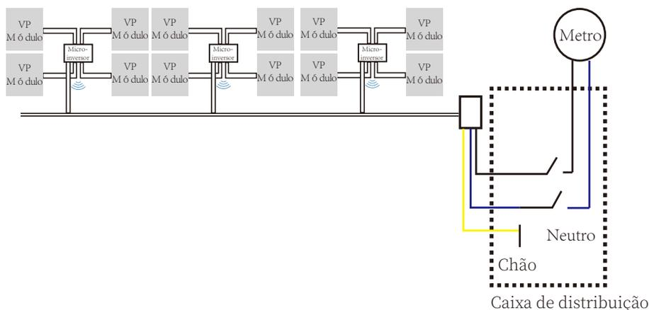
**AVISO:** O código de cores da fiação pode ser diferente de acordo com a regulamentação local. Verifique todos os fios da instalação antes de conectar ao cabo CA para ter certeza de que correspondem. Cabeamento incorreto pode danificar irreparavelmente os Microinversores, tal problema não é coberto pela garantia.
