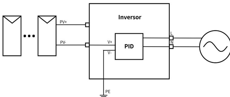
O módulo Anti-PID repara o efeito PID do módulo fotovoltaico à noite. O módulo PID sempre funciona quando conectado à CA.
