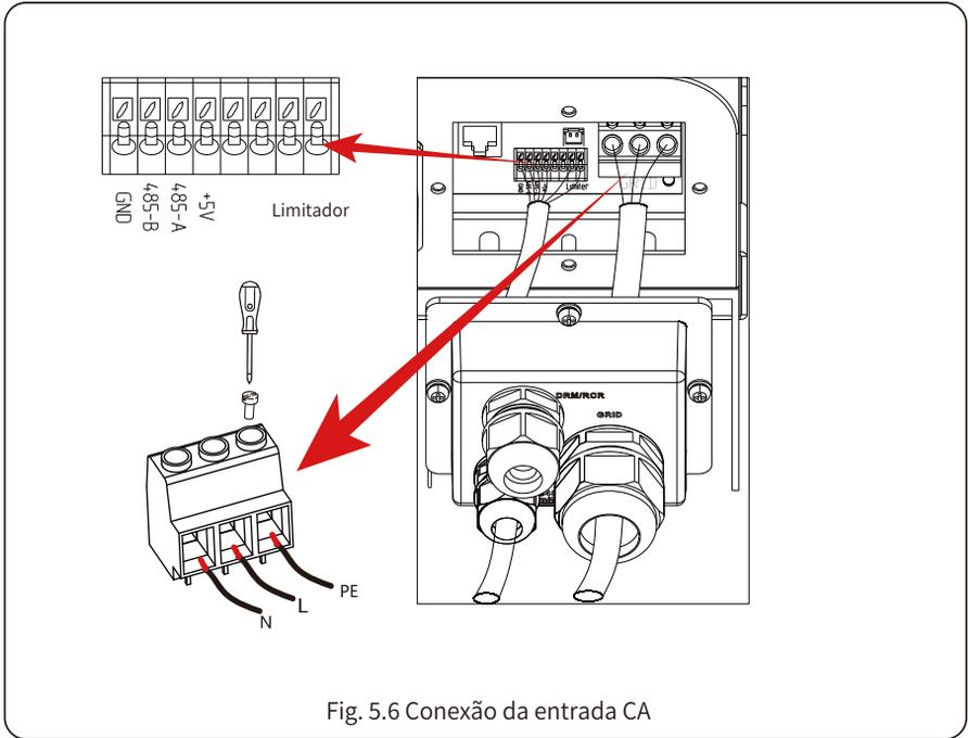
Fig. 5.6 Conexão da entrada CA
