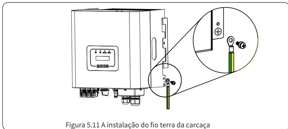
Figura 5.11 A instalação do fio terra da carcaça
