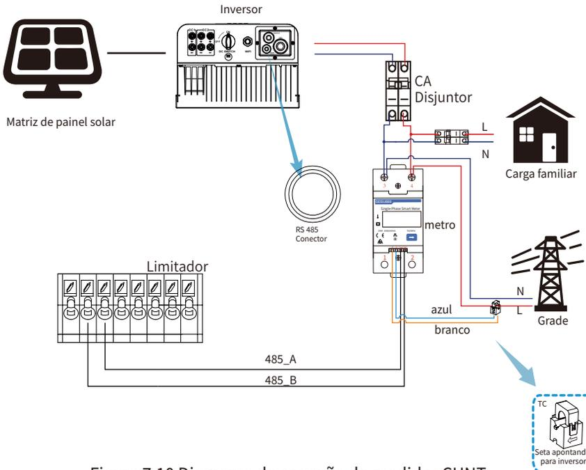
Figura 7.10 Diagrama de conexão do medidor CHINT
