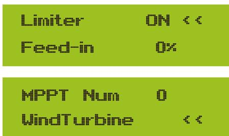
Feed\_In%: é usado para implantar quanto a energia pode ser alimentada na rede. Por exemplo, Feed\_in=50% do modelo 4W, o que significa Max. A potência de 2KW pode ser alimentada grid. E este parâmetro é válido somente após conectar um medidor e a função do medidor estiver "ON".
