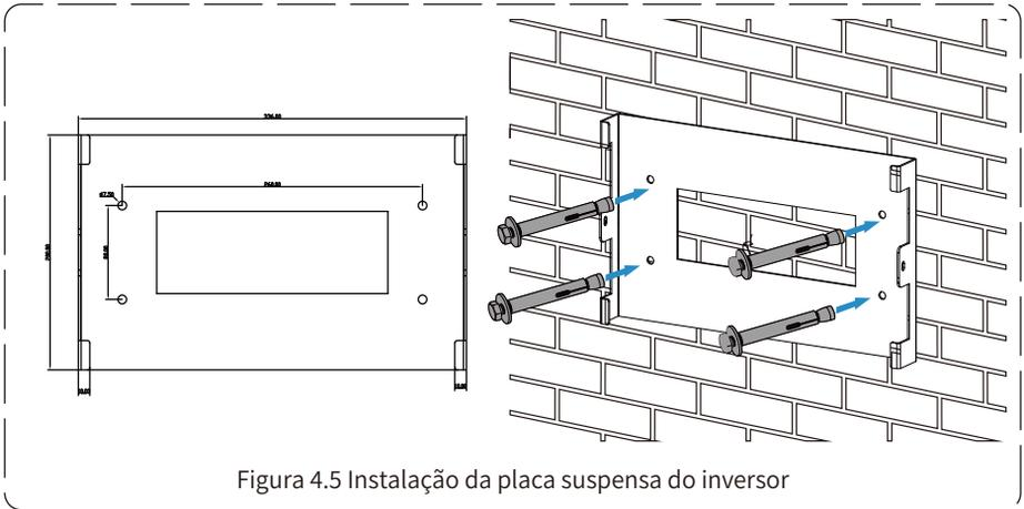
Figura 4.5 Instalação da placa suspensa do inversor
