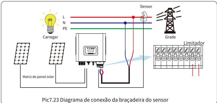
Pic7.23 Diagrama de conexão da braçadeira do sensor
