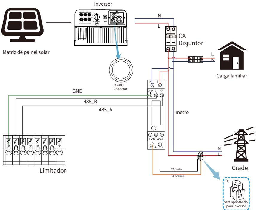
Figura 7.5 Diagrama de conexão do medidor EASTRON
