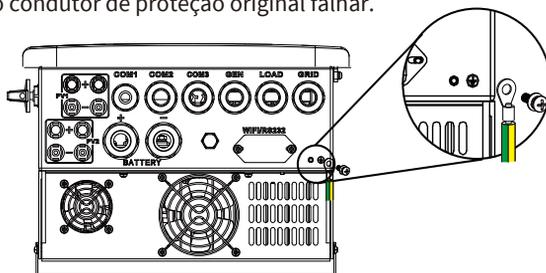
Conexão de aterramento (fios de cobre)
