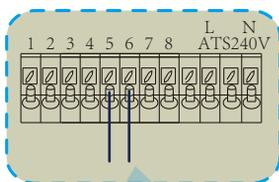
Partida/Válvula - G (5,6/7,8): sinal de contato seco para partida do gerador a diesel. Quando o "sinal GER" estiver ativo, o contato aberto (Partida/Válvula- G) será ligado (nenhuma saída de tensão). Se o "Sinal MODO INSULAR" estiver marcado, a porta da válvula G será o sinal de contato seco para partida do gerador a diesel. Se o "Sinal MODO INSULAR" não estiver marcado, a porta da partida G será o sinal de contato seco para partida do gerador a diesel.
