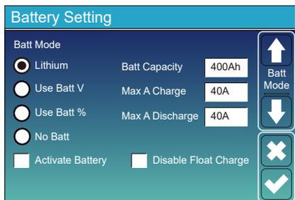
**Capacidade da bateria:** Quando o “Modo da Bateria” é definido como “Usar % da bateria”, a capacidade da bateria pode ser usada para calibrar o SOC da bateria.
