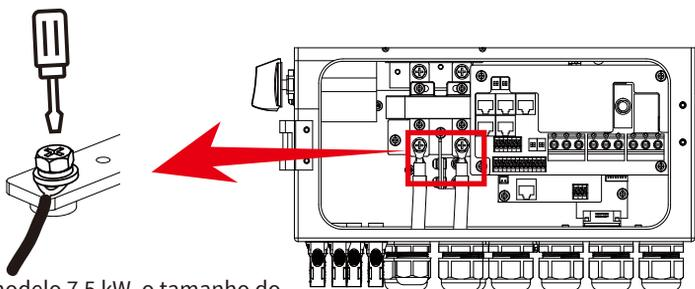
Para o modelo 7,5 kW, o tamanho do parafuso do conector da bateria deve ser M6
