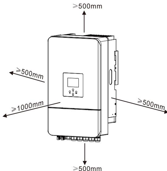
Para ter uma circulação de ar adequada para dissipar o calor, mantenha um espaço de aprox. 50cm nas laterais, 50cm acima e abaixo da unidade e 100cm na lateral frontal.
