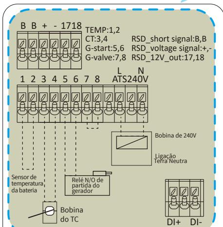
TEMP(1,2): sensor de temperatura da bateria da bateria de chumbo-ácido.
