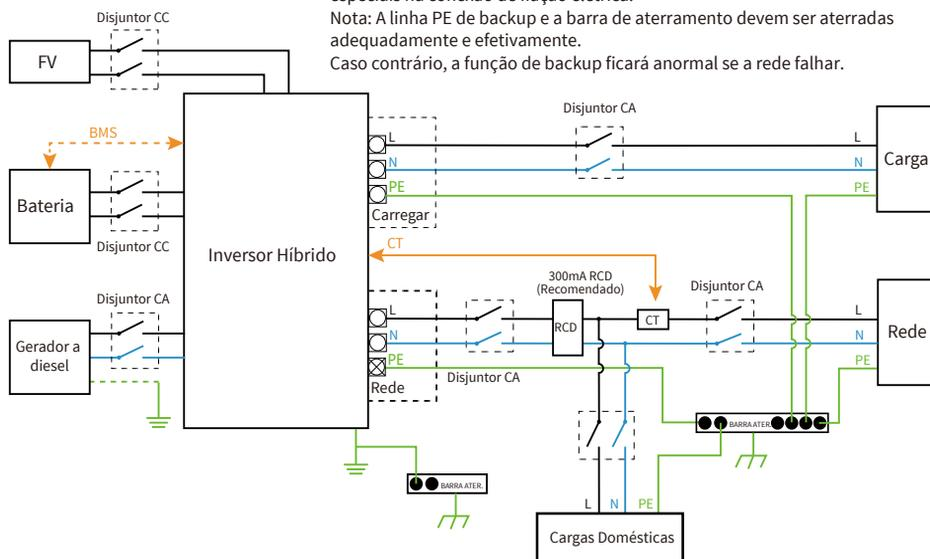
Este diagrama serve como exemplo para a aplicação em que o Neutro se conecta junto ao PE na caixa de distribuição.
