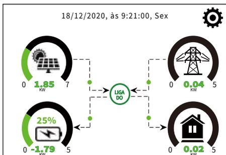
1.O ícone no centro da tela inicial indica que o sistema está em operação normal. Se ele mudar para "comm,/FXX", significa que o inversor tem erros de comunicação ou outros erros, e a mensagem de erro será exibida sob este ícone (erros FXX, as informações detalhadas de erros podem ser visualizadas no menu Alarmes do sistema).
