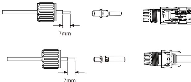
Figura 3.3 Desmontagem da porca de capa do conector
