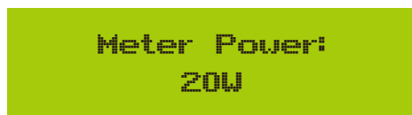
Figura 7.21 Função de exportação zero via medidor de energia ativado
